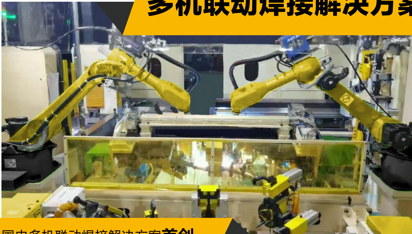
汽车尾气管多机联动焊接
