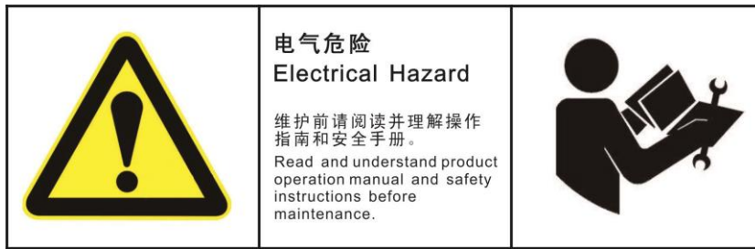
图 1-6 控制柜电气危险标识
